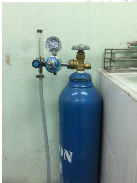
ก. ถังก๊าซอาร์กอน
