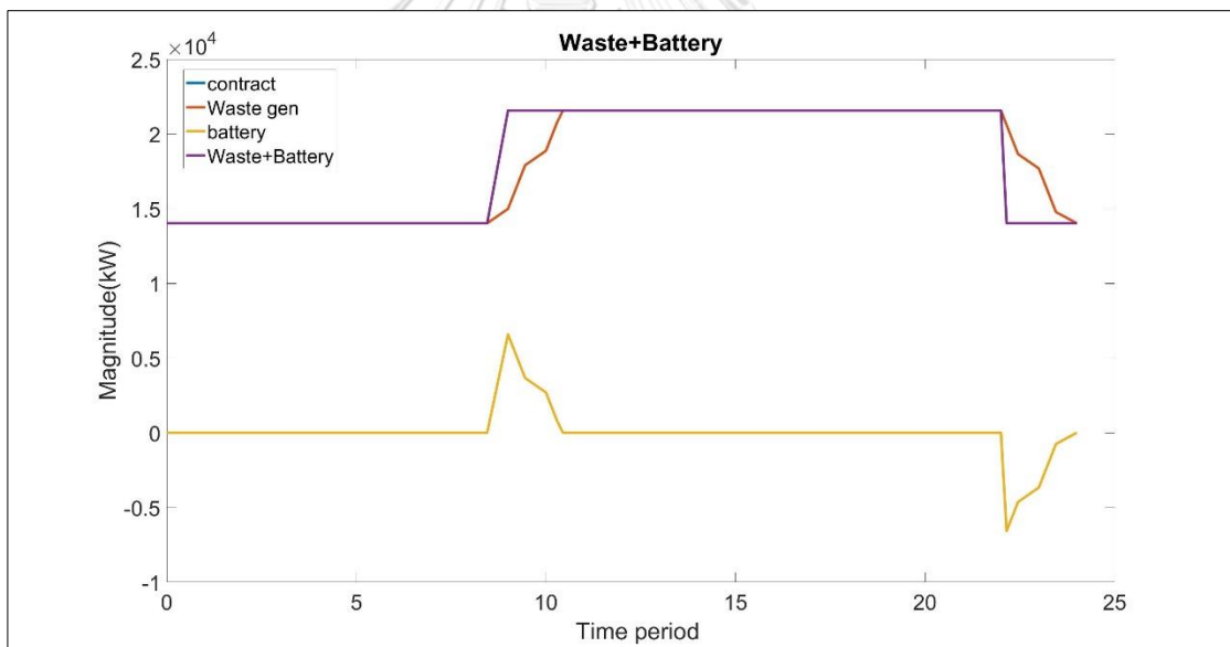
รูปที่ 6.11 รูปแบบการเดินเครื่องของระบบผลิตไฟฟ้าพลังงานขยะทำงานร่วมกับระบบกักเก็บพลังงานด้วยแบตเตอรี่
