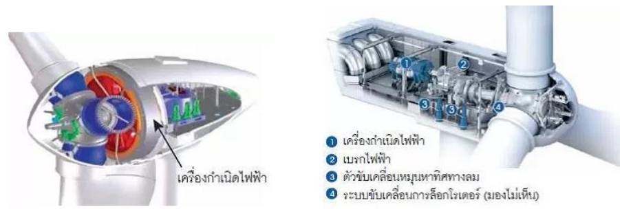
รูปที่ 28 แสดงรายละเอียดเครื่องกำเนิดไฟฟ้าของกังหันลม
