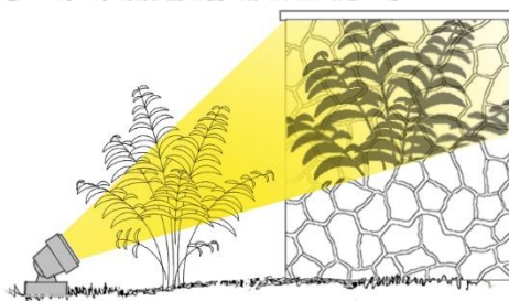
ภาพ 2.12 การส่องสว่างแบบให้เกิดเงา (shadowing)
