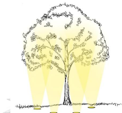
ภาพ 2.9 การให้แสงแบบฉายขึ้น (uplight)
