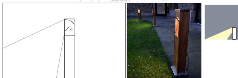
ภาพ 2.27 ดวงโคมสนามแบบเสาเดี่ยว (bollard luminaires)
