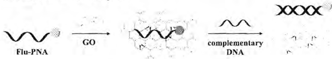
รูปที่ 24 หลักการทำงานของ GO-PNA DNA sensor ที่พัฒนาขึ้นในงานวิจัยนี้
