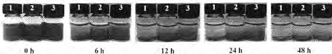
ภาพ 61 การทดสอบการกระจายตัวในน้ำของอนุภาคก่อนเคลือบด้วยพอลิอะไครลิกแอซิด (MNP-Ac), อนุภาคที่เคลือบด้วยพอลิเมอร์พอลิอะไครลิกแอซิด (MNP-PAA) และอนุภาคที่ตรึงด้วย acpcPNA (MNP-PNA)
