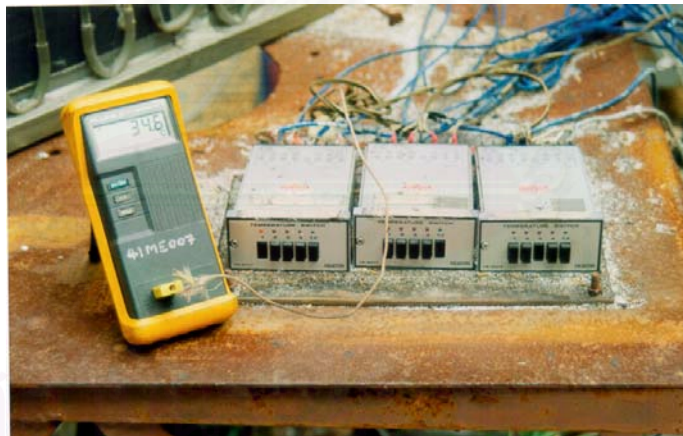
รูปที่ 5.11 แสดงการติดตั้งเทอร์โมคัปเปิลและ Display สำหรับระบบวัดอุณหภูมิ
