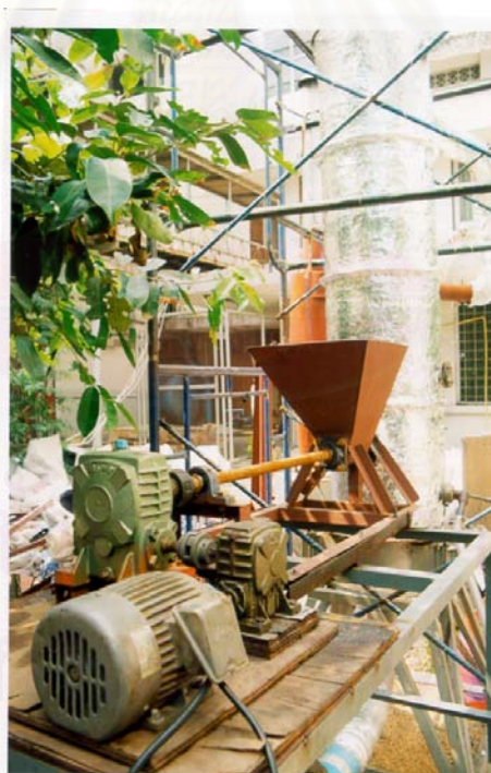
รูปที่ 5.7 แสดงภาพถ่ายอุปกรณ์ปั๊มแบบสกรู
