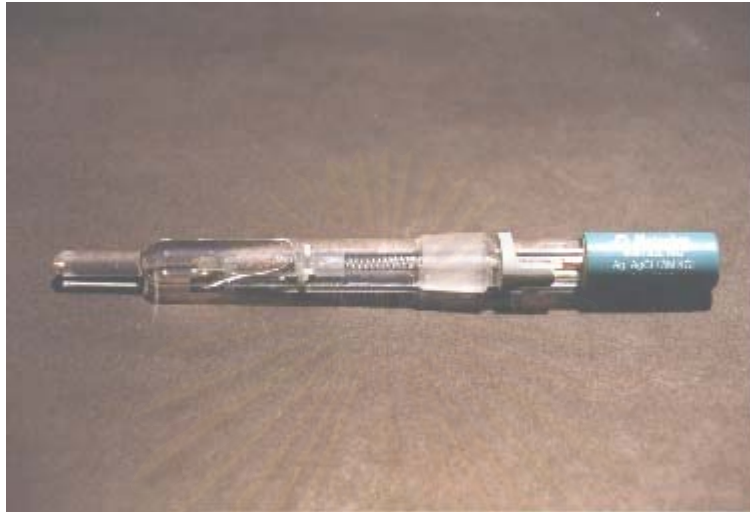
รูป 3.2 แสดงอิเล็กโทรดอ้างอิง ( Ag/AgCl )
