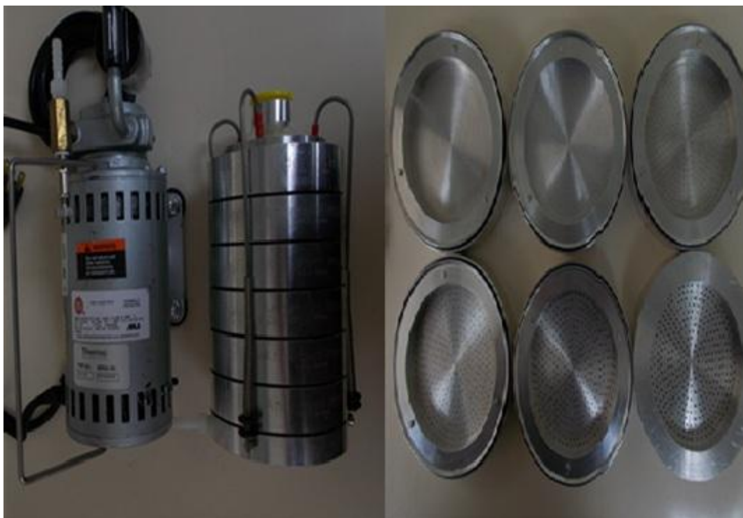
ภาพที่ 6 เครื่อง The six-stage viable Andersen cascade impactor
