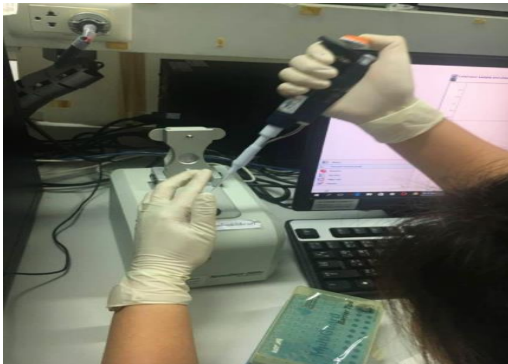
รูปภาพที่ 12 แสดงการเตรียมการวัดค่าการดูดกลืนแสง
