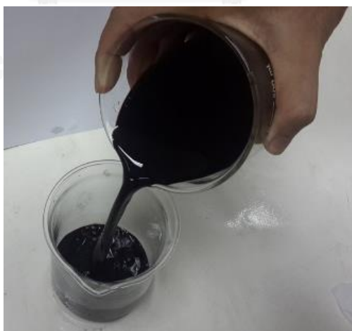
รูปที่ 14 ลักษณะของน้ำดำที่มาจากกระบวนการต้มเยื่อแบบต่อเนื่อง
