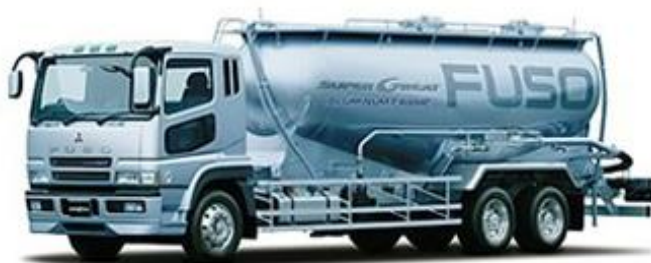
รูปที่ 13 รถไซโลหรือรถบัลค์ที่ใช้ในการขนส่งเถ้า
