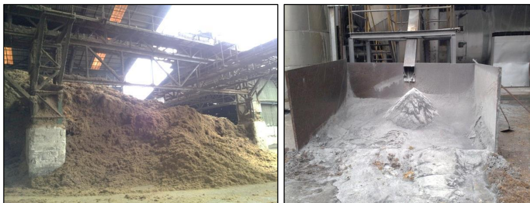
รูปที่ 9 กากปาล์มน้ำมันก่อนการเผาเพื่อเป็นเชื้อเพลิง และ กากปาล์มน้ำมันหลังจากการเผา (ที่มา : เก็บจากโรงงานอุตสาหกรรม วัสดุปอชโซลันที่ดีสำหรับงานคอนกรีต)
