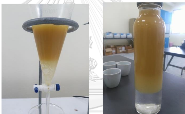
รูปที่ 3.22 การทำปฏิกิริยาโดยใช้เถ้ากะลาปาล์มที่อุณหภูมิ 800 °C
