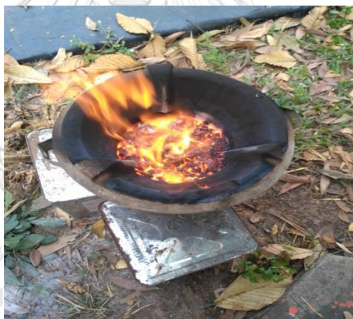
รูปที่3.15 การเตรียมเถ้ากะลาปาล์มเพื่อใช้เป็นตัวเร่งปฏิกิริยา
