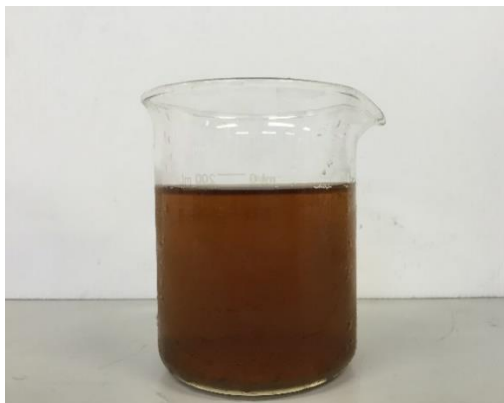
ภาพที่ 4.6 น้ำเสียที่ออกมาจากบ่อเติมอากาศก่อนการเติมสารส้ม (ครั้งที่ 2)
