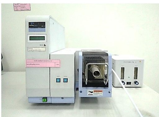
รูปที่ 3.2 เครื่องวิเคราะห์การสลายตัวด้วยความร้อน ยี่ห้อ Pyris Diamond รุ่น Perkin Elmer
