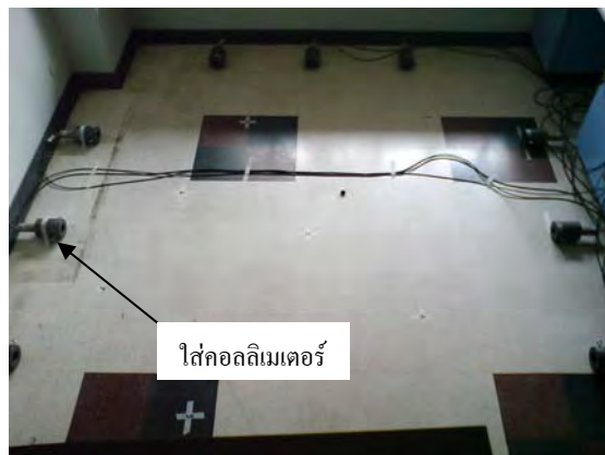
รูปที่ 3.22 การใส่คอยล์เมเตอร์ให้กับหัววัดในพื้นที่สี่เหลี่ยมห้องขนาด 2.6 เมตร x 3 เมตร
