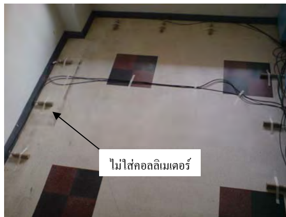
รูปที่ 3.21 การไม่ใส่คอยล์เมเตอร์ให้กับหัววัดในพื้นที่สี่เหลี่ยมห้องขนาด 2.6 เมตร x 3 เมตร
