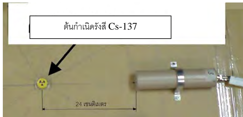
รูปที่ 3.12 การจัดวางต้นกำเนิดรังสี Cs-137 กับหัววัดโซเดียมไอโอไดต์ NaI(Tl) ระยะห่าง 24 ซม.
