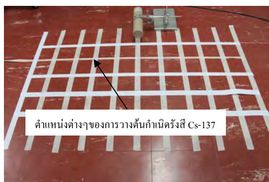
รูปที่ 3.17 การวัดรังสีโดยไม่มีคอลลิเมเตอร์
