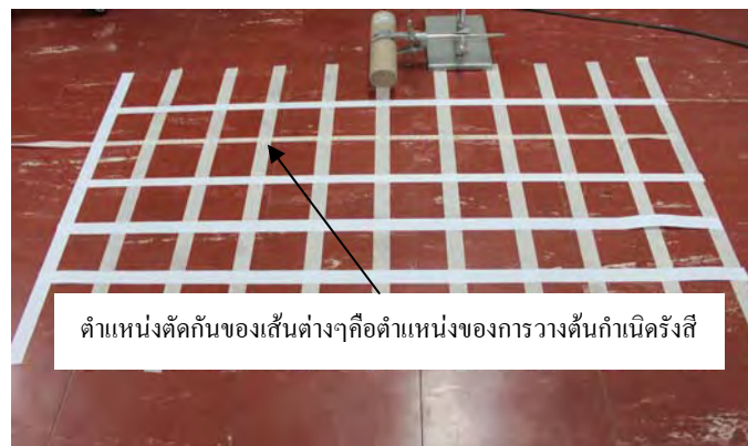
รูปที่ 4.9 แสดงตำแหน่งของการวางต้นกำเนิดรังสี Cs-137 ความแรงรังสี 100 \mu\text{Ci} (3.7 MBq) ในการศึกษาผลของการใช้คอลลิเมเตอร์ต่ออัตรานับรังสี
