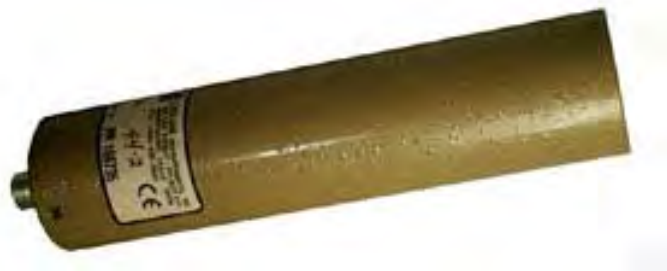
รูปที่ 3.1 หัววัดรังสีชนิดโซเดียมไอโอไดด์ (ทัลเลียม) Ludlum Model 44-2 ขนาด 1 นิ้ว x 1 นิ้ว
