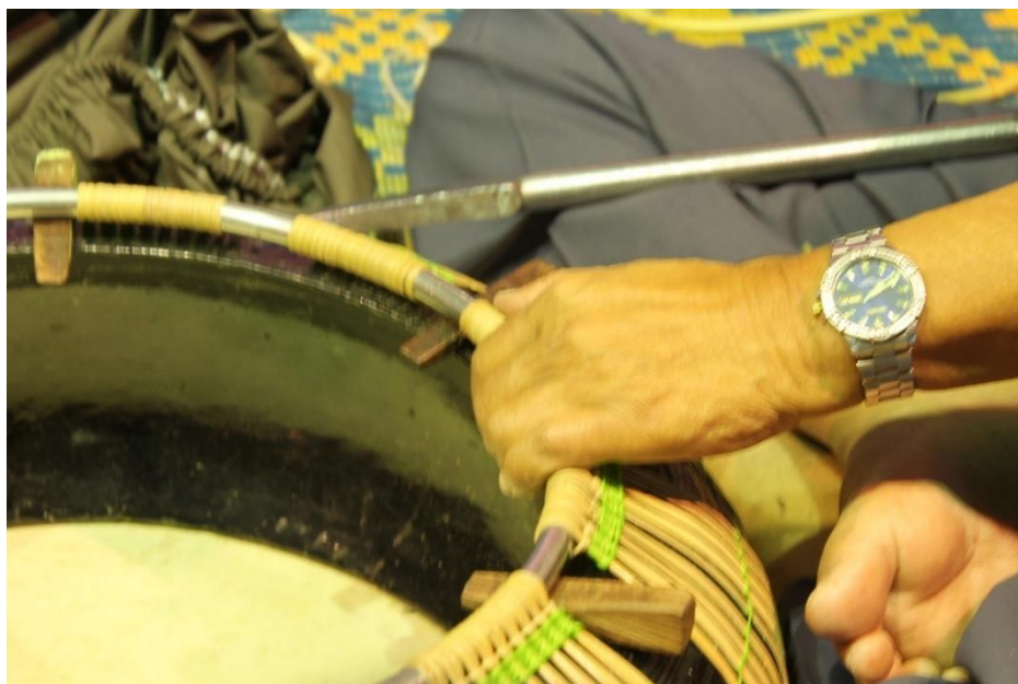
ภาพที่ 3.8 การใช้เหล็กงัดรามาเพื่อใส่ลิ้ม ที่มาภาพ: นายนิรุจน์ วงศ์สุวรรณ
