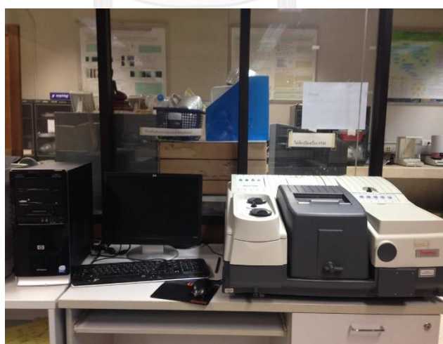
รูปที่ 3. 4 เครื่องฟูเรียร์ทรานส์ฟอร์มอินฟราเรดสเปกโตรสโกปี
