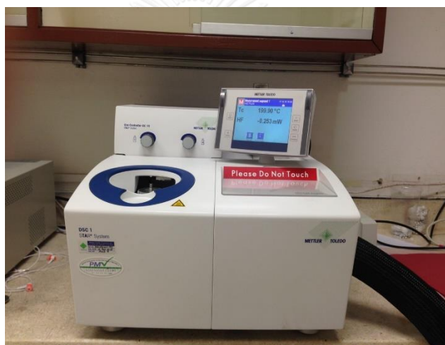
รูปที่ 3. 8 เครื่องดีพีเพอเรนเชียลสแกนนิ่งแคลอริมิเตอร์
