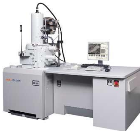
รูปที่ 3. 9 กล้องจุลทรรศน์อิเล็กตรอนแบบส่องกราด [35]
