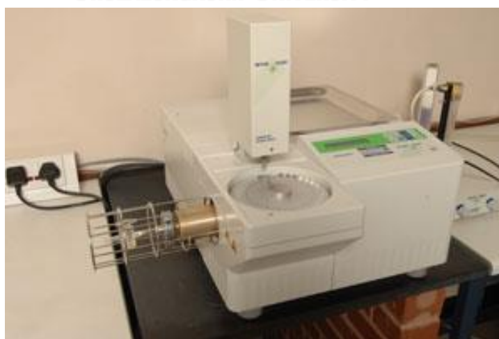
รูปที่ 3. 7 เครื่องวิเคราะห์น้ำหนักภายใต้ความร้อน [34]
