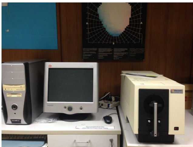
รูปที่ 3. 6 เครื่องวัดสี
