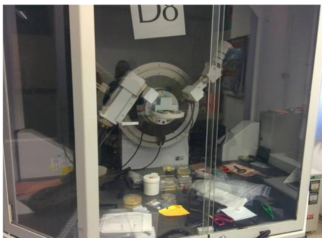
รูปที่ 3. 5 เครื่องวิเคราะห์การเลี้ยวเบนรังสีเอ็กซ์ [33]
