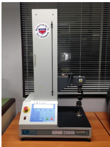
รูปที่ 3. 10 เครื่องทดสอบอเนกประสงค์
