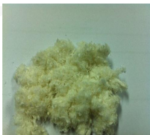
รูปที่ 4. 1 (ซ้าย) ต้นยาสูบที่ผ่านการตากแห้ง (ขวา) เยื่อเซลลูโลสที่สกัดได้
