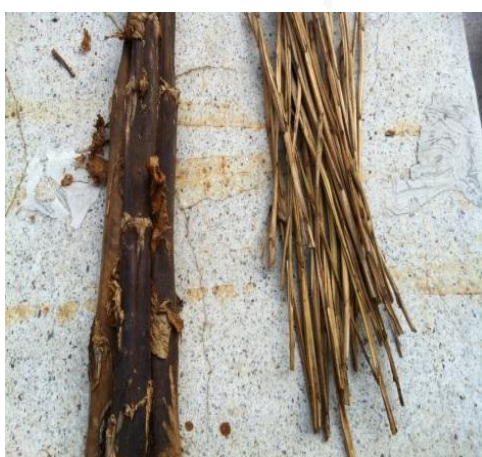
รูปที่ 4. 1 (ซ้าย) ต้นยาสูบที่ผ่านการตากแห้ง (ขวา) เยื่อเซลลูโลสที่สกัดได้
