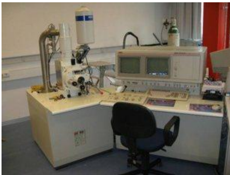
รูปที่ 3. 6 กล้องจุลทรรศน์อิเล็กตรอนแบบส่องกราด บริษัท jeol รุ่น jsm 6400
