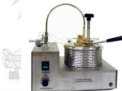
รูปที่ ฉ.3 Pensky–Martens Closed Cup apparatus
