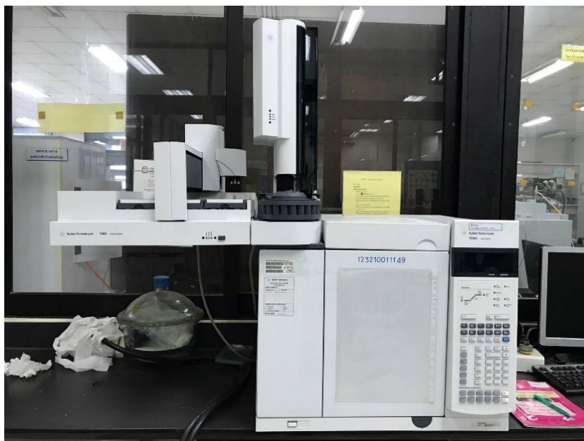
รูปที่ 3.3 เครื่องแก๊สโครมาโทกราฟ (Gas chromatograph, GC)
