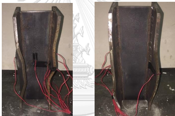
ภาพที่ 5.1 รูปแบบการวิบัติของเสา H100X100 (Mode 1)
