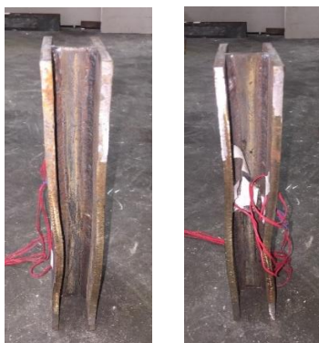
ภาพที่ ค-2 รูปแบบการวิบัติของเสาเหล็กเชื่อมประกอบ H50X100 (Mode 2)
