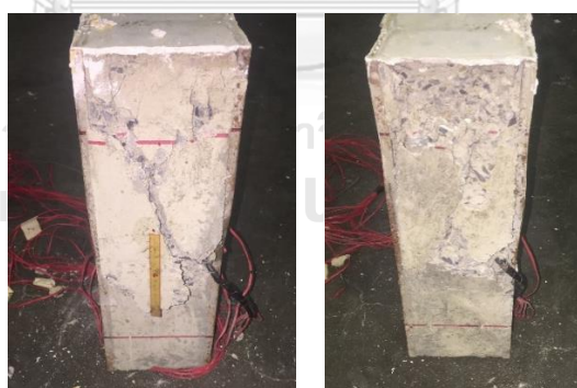
ภาพที่ ค-24 รูปแบบการวิบัติของตัวอย่างทดสอบ HRC (D) (mode 3)
