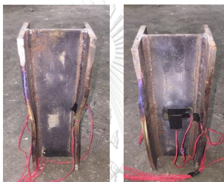
ภาพที่ ค-3 รูปแบบการวิบัติของเสาเหล็กเชื่อมประกอบ H100X80 (Mode 1)
