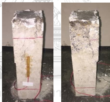
ภาพที่ ก-2 รูปแบบการวิบัติของคอนกรีต C100X80
