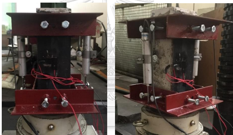
ภาพที่ 4.10 การติดตั้ง LVDT และอุปกรณ์เหล็กสี่เหลี่ยมครอบตัวอย่างทดสอบ
