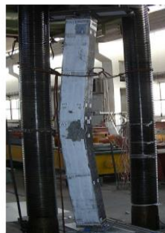
ภาพที่ 2.32 หน้าตัดและรูปแบบการวิบัติของเสาเหล็กหุ้มด้วยคอนกรีตประเภท Sx [16]
