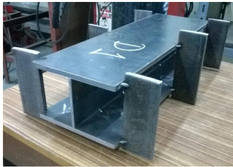
ภาพที่ ข-5 เชื่อมเหล็กด้านข้างเพื่อป้องกันการบิดตัวเนื่องจากการเชื่อมแข็ง
