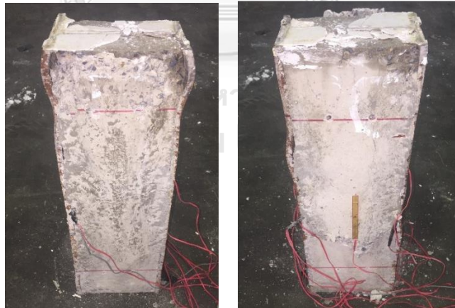
ภาพที่ ค-21 รูปแบบการวิบัติของตัวอย่างทดสอบ HC150X100 (mode 1)
