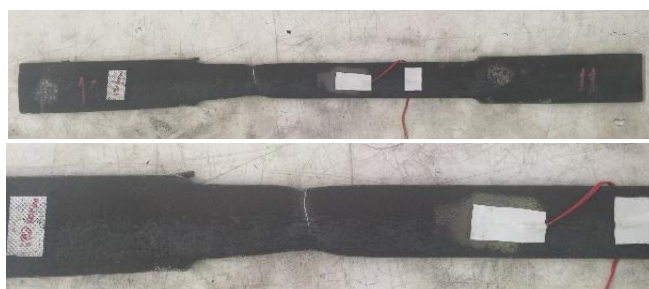
ภาพที่ ก-9 รูปแบบการวิบัติของแผ่นเหล็กรับแรงดึง
