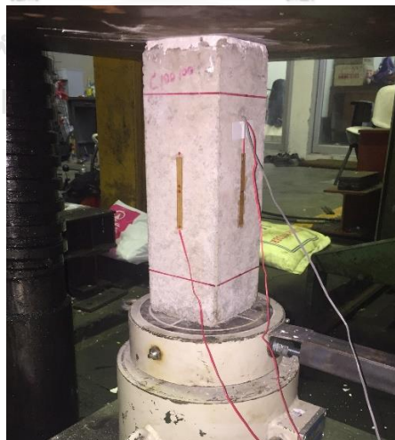
ภาพที่ 4.3 การทดสอบกำลังรับแรงอัดประลัยของเสาคอนกรีตทรงปริซึมสี่เหลี่ยม
