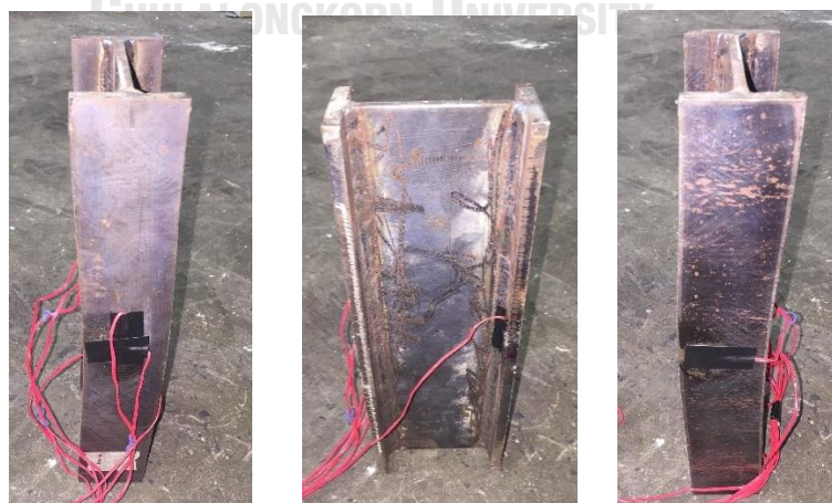
ภาพที่ 5.2 รูปแบบการวิบัติของเสา H100X50 (Mode 2)
