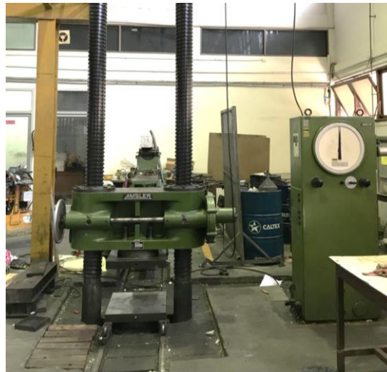
ภาพที่ 4.12 เครื่องทดสอบกำลังรับแรงอัด Amsler 500 ตัน
