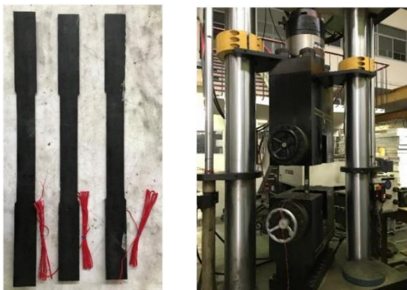
ภาพที่ 4.5 การทดสอบกำลังที่จุดครากของแผ่นเหล็กด้วยเครื่อง Instron
