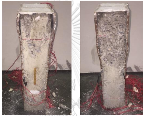
ภาพที่ ค-20 รูปแบบการวิบัติของตัวอย่างทดสอบ HC100X150 (mode 1)
