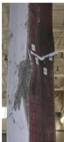
ภาพที่ 2.32 หน้าตัดและรูปแบบการวิบัติของเสาเหล็กหุ้มด้วยคอนกรีตประเภท Sx [16]
