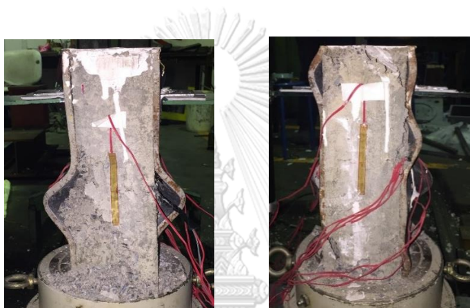
ภาพที่ 5.5 รูปแบบการวิบัติของตัวอย่างทดสอบ HC100X100 (mode 1)
