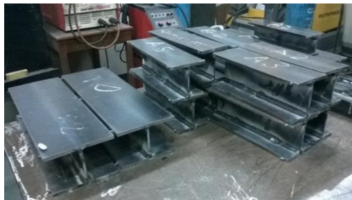
ภาพที่ ข-7 ถอดแผ่นด้านข้างออกหลังจากการเชื่อมแข็ง
