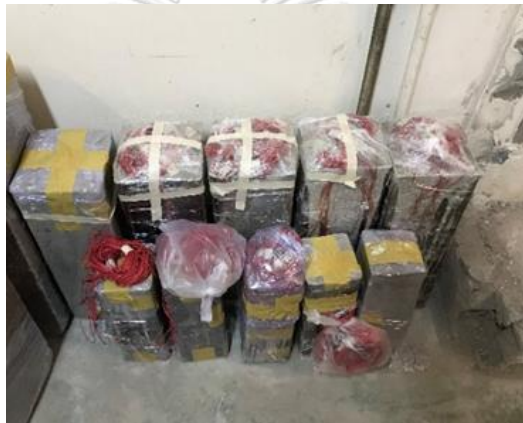
ภาพที่ 4.2 การบ่มคอนกรีตโดยใช้พลาสติกหุ้มรอบตัวอย่างทดสอบ
