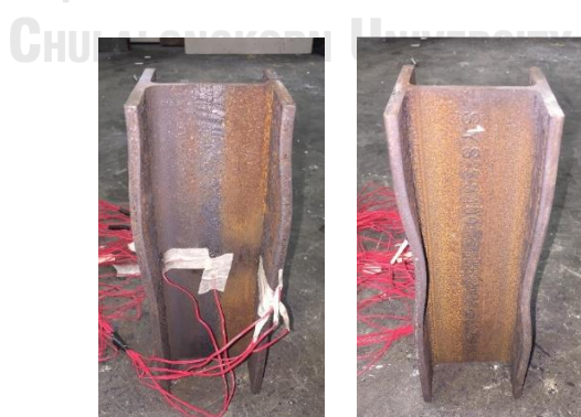
ภาพที่ ค-1 รูปแบบการวิบัติของเสาเหล็กเชื่อมประกอบ W100X100 (Mode 1)
