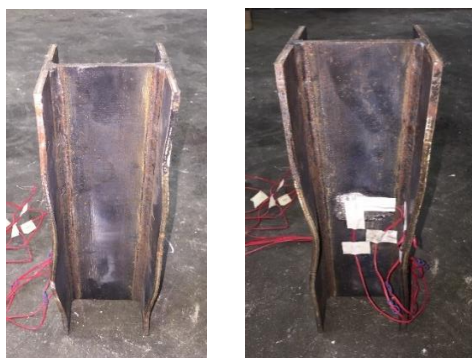
ภาพที่ ค-5 รูปแบบการวัดของเสาเหล็กเชื่อมประกอบ H96X100 (Mode 1)
