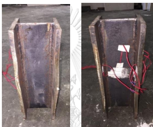
ภาพที่ ค-6 รูปแบบการวัดของเสาเหล็กเชื่อมประกอบ H104X100 (Mode 1)
