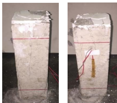
ภาพที่ ก-3 รูปแบบการวิบัติของคอนกรีต C100X100
