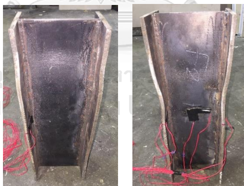
ภาพที่ ค-4 รูปแบบการวิบัติของเสาเหล็กเชื่อมประกอบ H150X100 (Mode 1)
