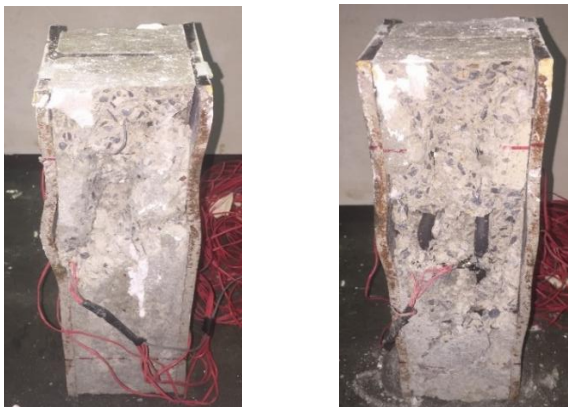
ภาพที่ 5.7 รูปแบบการวิบัติของตัวอย่างทดสอบ HRC (D/2) (mode 3)
