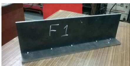
ภาพที่ ข-3 ประกอบแผ่นเหล็กฝั่งแรก
