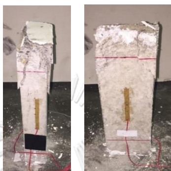
ภาพที่ ก-1 รูปแบบการวิบัติของคอนกรีต C100X50
