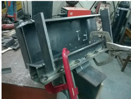
ภาพที่ ข-6 เตรียมการเชื่อมแข็งตลอดแนวยาวของรอยต่อ
