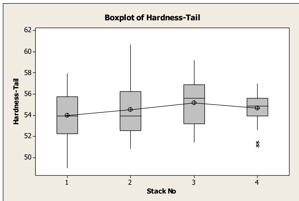
รูปที่ 3.50 Boxplot ระหว่าง Stack no. กับ Hardness HRB ตำแหน่งท้ายม้วน
