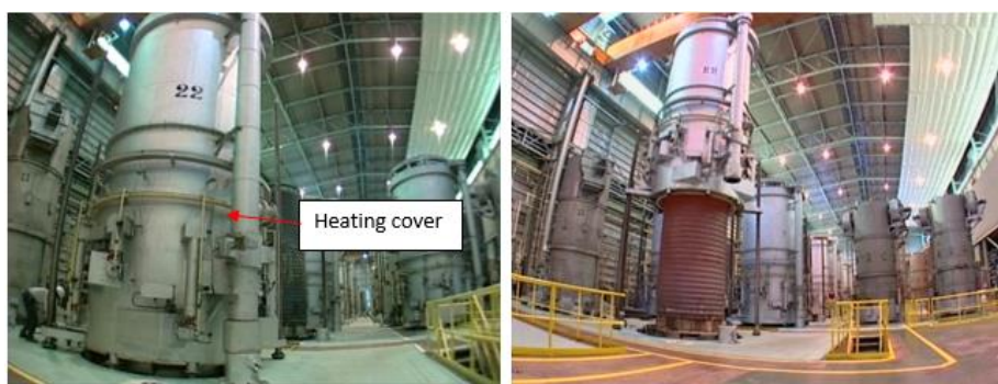
รูปที่ 1.15 ลักษณะการครอบเตาด้านนอก (Heating cover) และทำการยก Heating cover ออก
