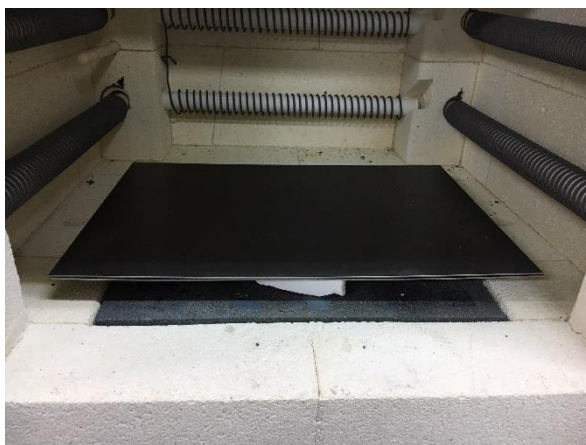
รูปที่ 4.3 เตาอบที่ใช้ในการทดลอง Nabertherm C30
