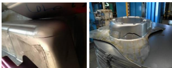
รูปที่ 1.28 ตัวอย่างปัญหาขึ้นรูปแล้วแตก สาเหตุจาก %Elongation ต่ำ
