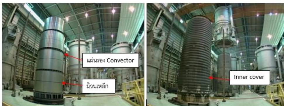
รูปที่ 1.12 ลักษณะการวางม้วนเหล็กจำนวน และการครอบด้วยเตาด้านใน (Inner cover)
