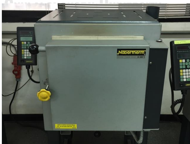
รูปที่ 4.2 เตาอบที่ใช้ในการทดลอง Nabertherm C30
