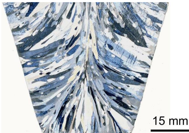
รูปที่ 47 - โครงสร้างจุลภาคหลังเย็นตัวหลังจากทำ intensive melt shearing ที่อุณหภูมิ 720°C เป็นเวลา 45 นาที ของโลหะอะลูมิเนียมผสม ที่เติม grain refiner ระบบ Al-5Ti-1B ร้อยละ 0.2 โดยน้ำหนัก [26]
