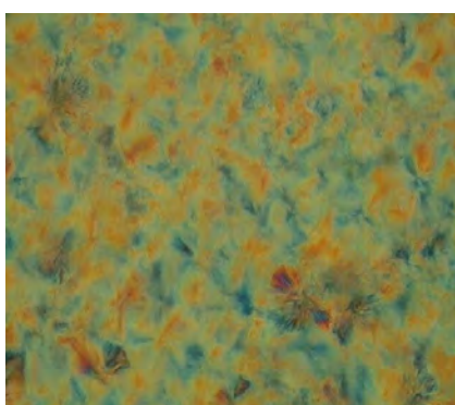
รูป ข-16 ภาพถ่ายของ PP/OMMT 2.5% ที่เตรียมจากกระบวนการขึ้นรูปแบบอัดจากกล้องจุลทรรศน์แบบแสงที่กำลังขยาย 400 เท่า
