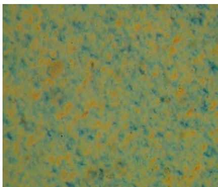
รูป ข-6 ภาพถ่ายของ PP/MMT 1.5% ที่เตรียมจากกระบวนการขึ้นรูปแบบอัดจากกล้องจุลทรรศน์แบบแสงที่กำลังขยาย 400 เท่า
