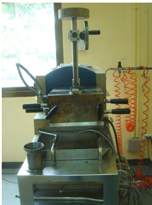
รูป ก-2 เครื่องผสมแบบปิด (Internal mixer, Haake)
