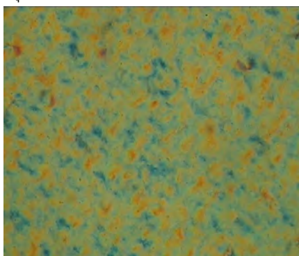
รูป ข-4 ภาพถ่ายของ PP/MMT 0.5% ที่เตรียมจากกระบวนการขึ้นรูปแบบอัดจากกล้องจุลทรรศน์แบบแสงที่กำลังขยาย 400 เท่า
