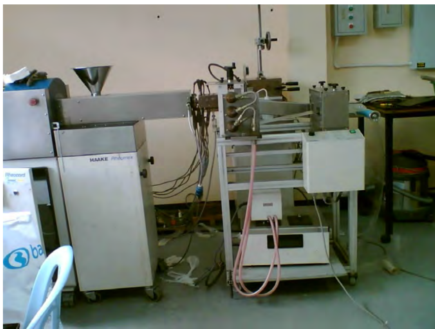
รูป ก-4 เครื่องขึ้นรูปแบบหล่อแผ่นสกรูเดียว (single-screw cast sheet, Haake)
