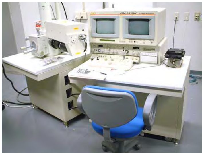
รูปที่ 3.9 เครื่อง Scanning Electron Microscope รุ่น JEOL JSM-5410LV
