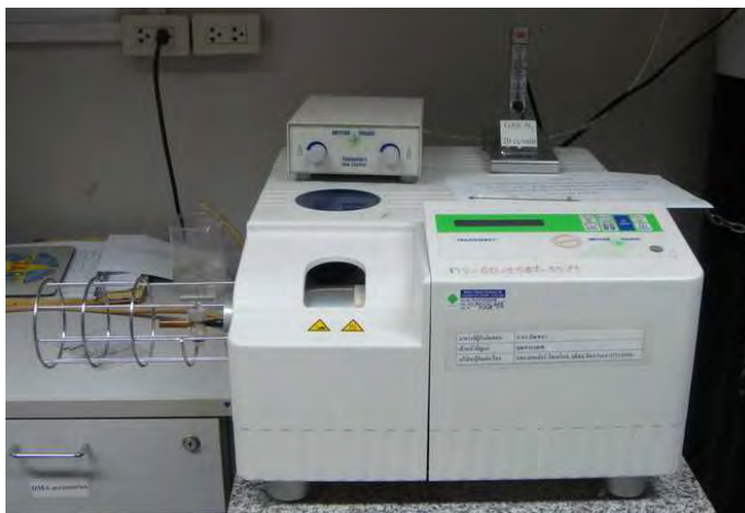
รูปที่ 3.4 เทอร์โมกราวิเมตริกแอนนาไลเซอร์
