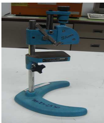
รูปที่ 3.9 เครื่องคูโรมิเตอร์ชนิด Shore D
