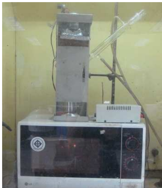
รูปที่ 3.2 ตู้อบไมโครเวฟที่ดัดแปลงเป็นพิเศษเพื่อใช้ในการทำปฏิกิริยา
