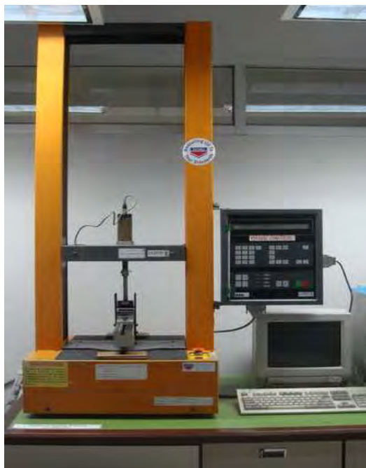
รูปที่ 3.8 เครื่องทดสอบแรงกดที่ติดตั้งชุดทดสอบแบบ three-point bending
