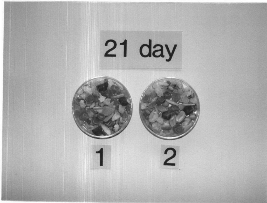
รูปที่ 19 มวลสีที่บรรจุใน (1) ถัง laminated foil และ (2) ถัง OPP/PE ภายใต้ความดันบรรยากาศ เก็บที่ 45 °C ความชื้นสัมพัทธ์ 48 % เป็นเวลา 21 วัน
