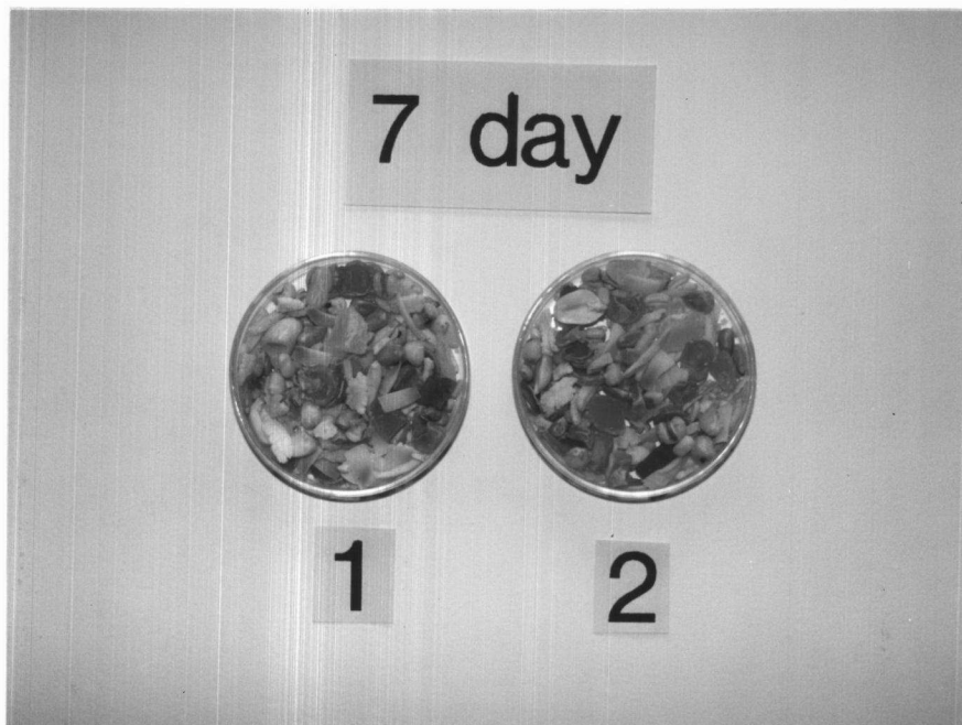
รูปที่ 20 มวลสีที่บรรจุใน (1) ถัง laminated foil และ (2) ถัง OPP/PE ภายใต้ความดันบรรยากาศ เก็บที่ 55 °C ความชื้นสัมพัทธ์ 28 % เป็นเวลา 7 วัน
