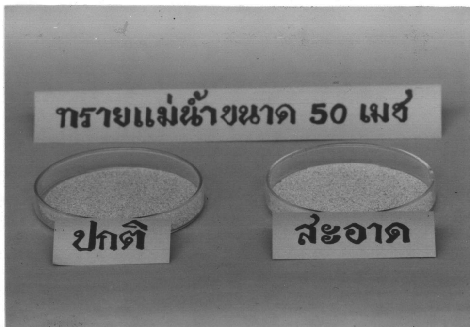
รูปที่ 17 เปรียบเทียบทรายแม่ข่ายขนาด 50 เมช ในสภาพปกติและหลังจาก ทำความสะอาดด้วยสารละลายกรดไนตริกเข้มข้น 14 นอร์มัล
