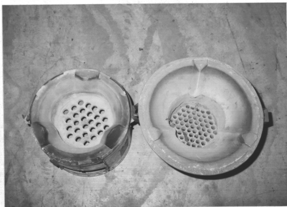
รูปที่ 3.22 ลักษณะที่วางภาชนะของเตาอังโล่เทียบกับเตาประสิทธิภาพสูงของกรมป่าไม้
