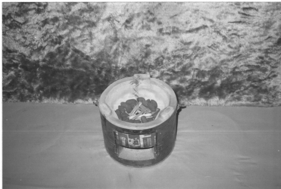
รูปที่ 3.19 ลักษณะการวางพื้นและชี้ใต้เพื่อการจุดติดของถ่านหินอัดก้อน
