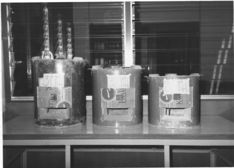
รูปที่ 3.14 เตาอั้งโล่ขนาด 27 ซม. ที่มี ความสูง 27 ซม., 32 ซม. และ 37 ซม.
