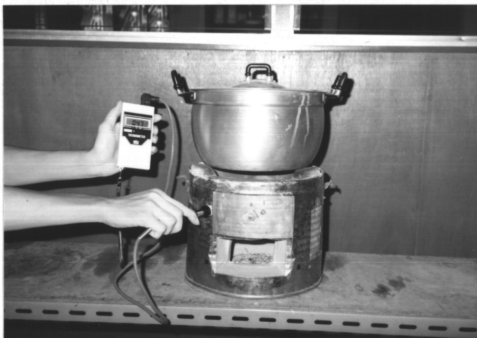
รูปที่ 3.15 การวัดอุณหภูมิที่ผิวของเตาโดยรอบ ใช้เครื่องมือวัดอุณหภูมิแบบไฟฟ้า พร้อมหัววัดแบบสัมผัสกับผิว
