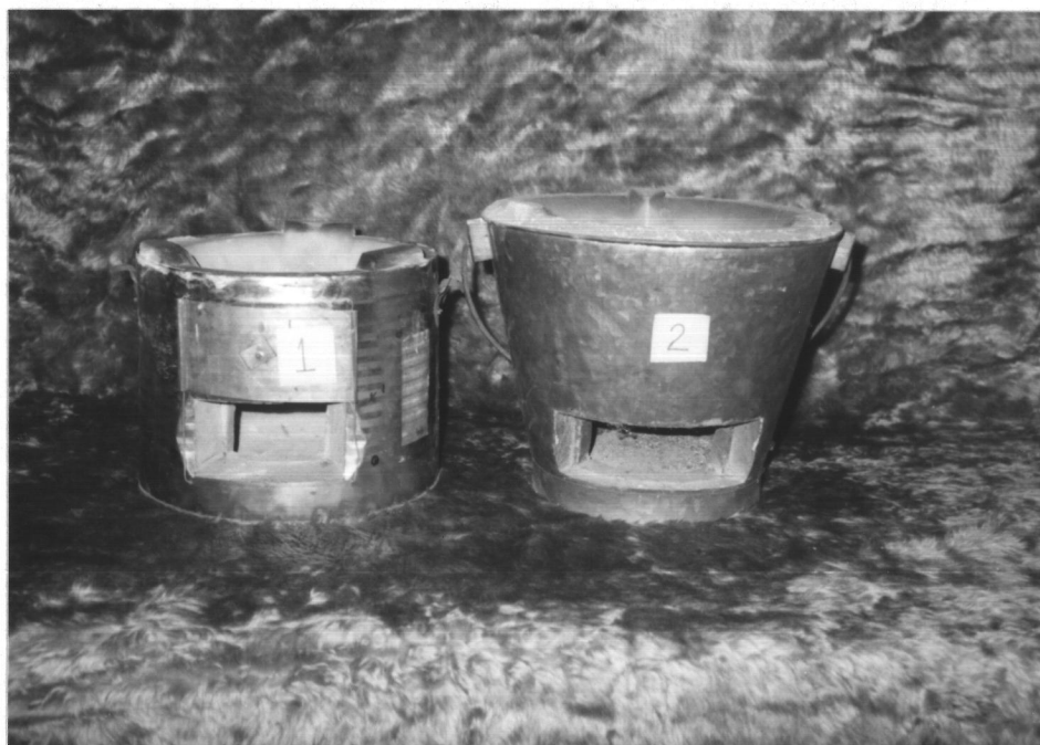
รูปที่ 3.5 เตาอังโล่ (1) เปรียบเทียบกับเตาประสิทธิภาพสูงของกรมป่าไม้ (2)
