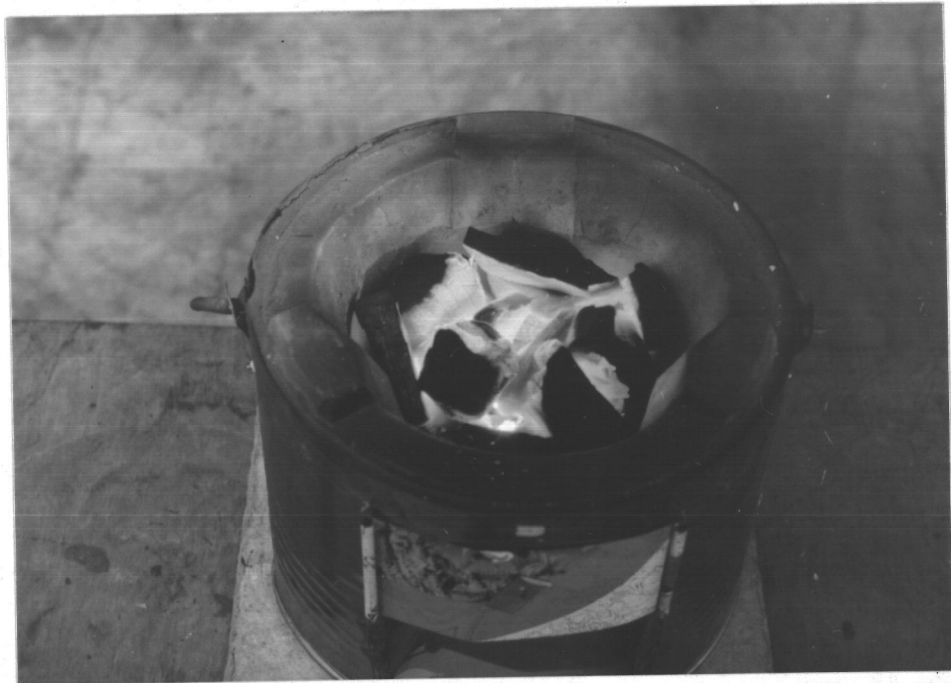
รูปที่ 4.11 ลักษณะการเผาไหม้ของถ่านไม้ในระยะเริ่มแรก
