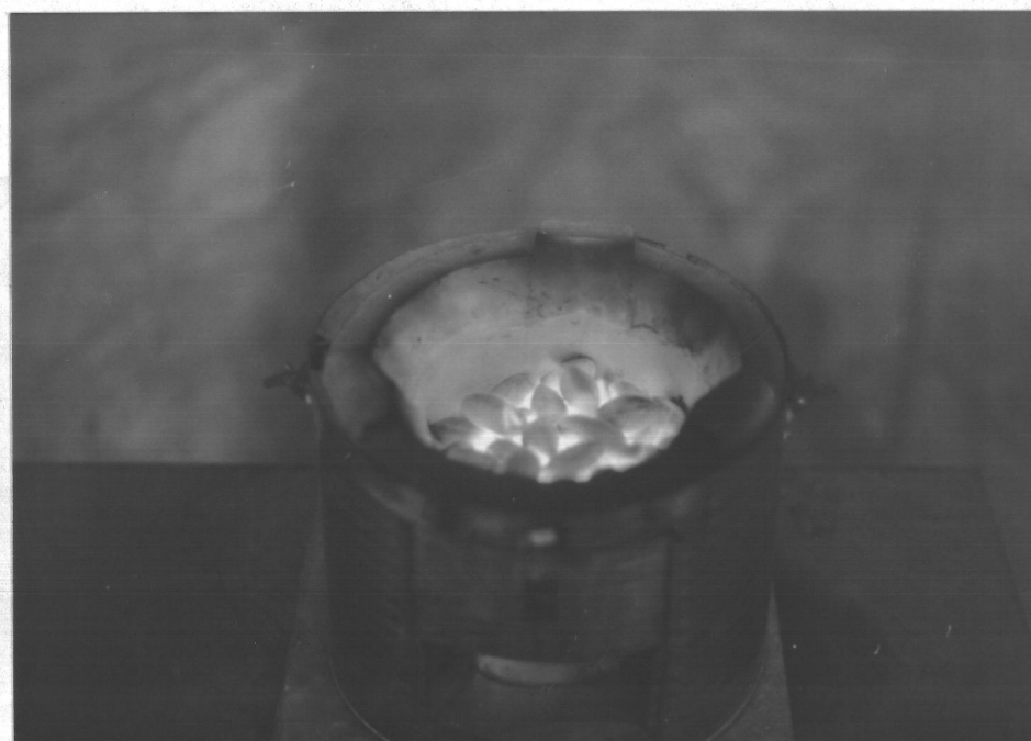
รูปที่ 4.14 ลักษณะการเผาไหม้ของถ่านหินอัดก้อนในระยะลุกแดงเต็มที่
