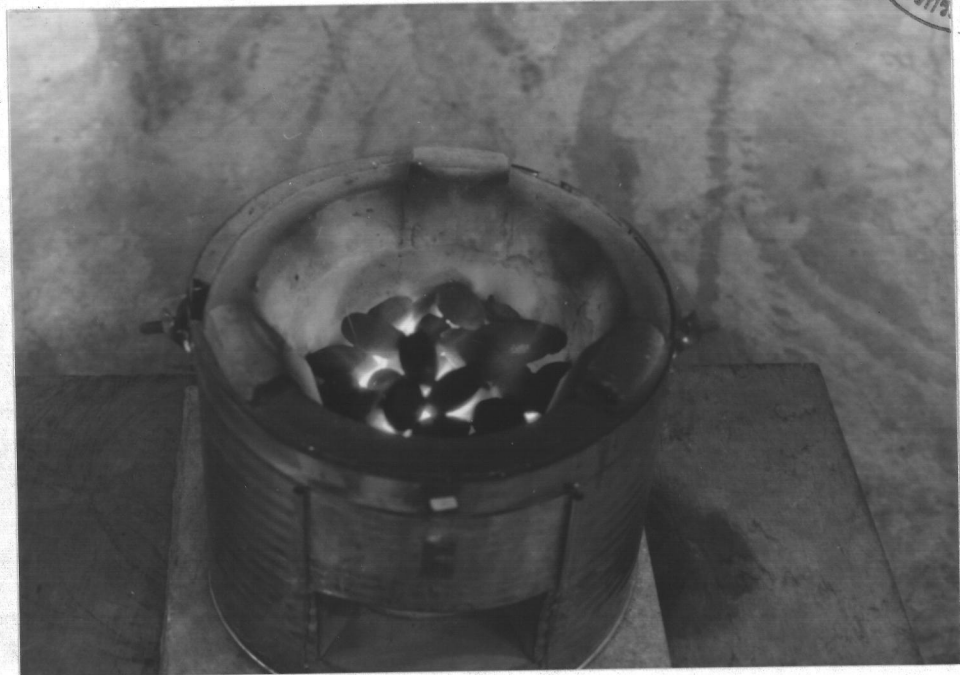
รูปที่ 4.12 ลักษณะการเผาไหม้ของถ่านหินอัดก้อนในระยะเริ่มแรก
