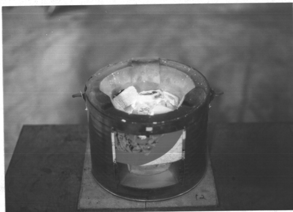
รูปที่ 4.13 ลักษณะการเผาไหม้ของถ่านไม้ในระยะลุกแดงเต็มที่
