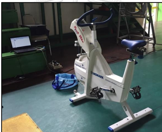
ภาพที่ 4 แสดงจักรยาน Wingate เครื่องหมายการค้า Monark,ergomadic 894 E
