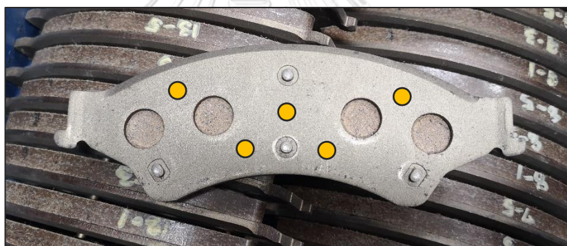
รูปที่ 3.13 ตำแหน่งการทดสอบค่าโมดูลัสยืดหยุ่นของผ้าเบรก
