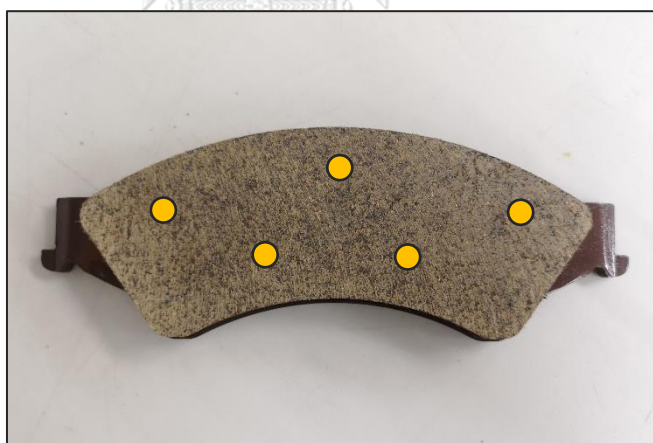
รูปที่ 3.11 ตำแหน่งการทดสอบความแข็งของผ้าเบรก
