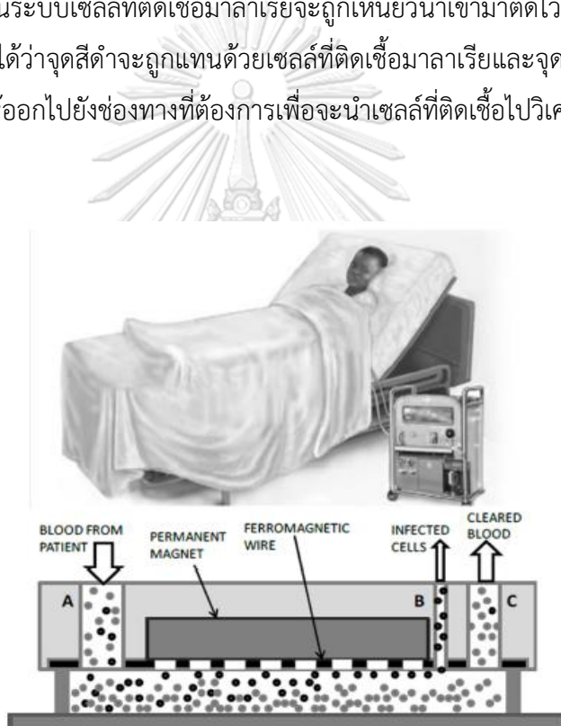
รูปที่ 2. 15 ระบบคัดแยกเซลล์ที่ติดเชื้อมาลาเรียโดยอาศัยการเหนี่ยวนำของแท่งเฟอร์โรแมกเนติก [16]
