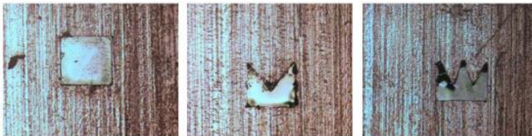
รูปที่ 4. 6 รูปร่างที่นิกเกิดติดอยู่บนแผ่นทองแดงหลังจากกระบวนการชุบโลหะนิกเกิดแล้วจึงเป็นโครงสร้างขนาดเล็ก รูปร่างสี่เหลี่ยม รูปร่างวีและรูปร่างดัดเบี้ยยู
