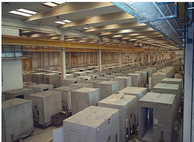
รูปที่ 3.2 โมดูลาร์ที่มีโครงสร้างเป็นคอนกรีตชนิดไม่เต็มรูปแบบและงานภายในแล้วเสร็จสมบูรณ์
