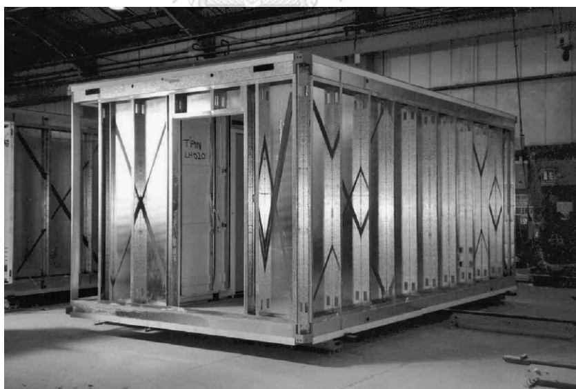
รูปที่ 1.1 โมดูลาร์ที่มีโครงสร้างเป็นเหล็กชนิดเต็มรูปแบบและงานภายในแล้วเสร็จสมบูรณ์
