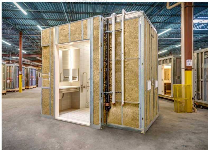
รูปที่ 3.1 โมดูลาร์ที่มีโครงสร้างเป็นเหล็กชนิดไม่เต็มรูปแบบและงานภายในแล้วเสร็จสมบูรณ์
