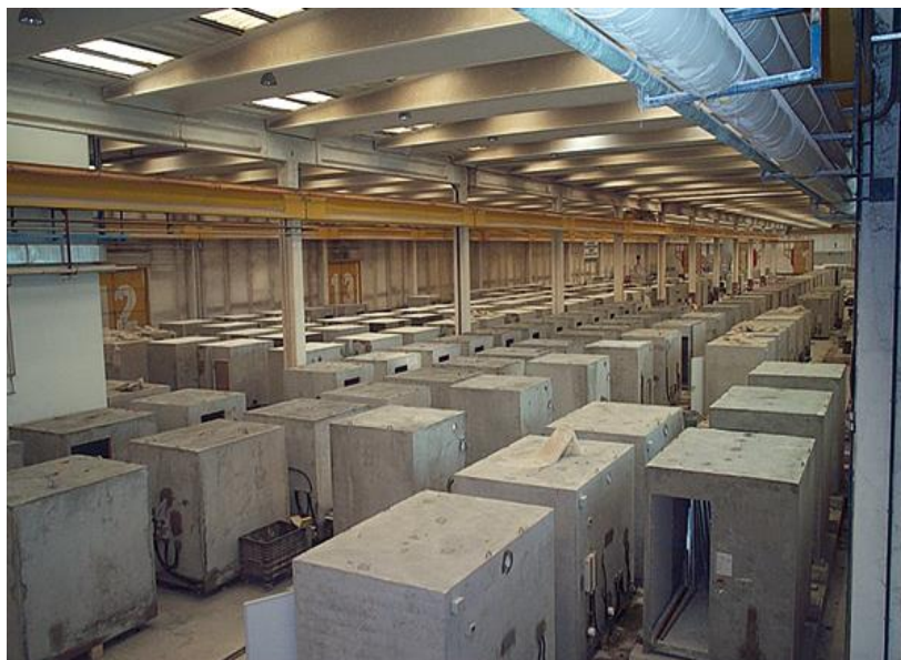
รูปที่ 3.2 โมดูลาร์ที่มีโครงสร้างเป็นคอนกรีตชนิดไม่เต็มรูปแบบและงานภายในแล้วเสร็จสมบูรณ์
