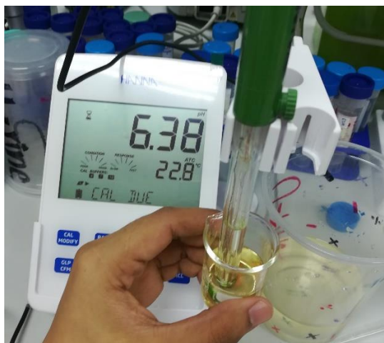
รูปที่ 29 แสดงการปรับค่า pH ของปัสสาวะด้วย HCL
