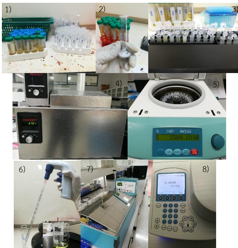
รูปที่ 30 แสดงขั้นตอนการวัดปริมาณแคลเซียมออกซาเลตด้วยวิธี iCOCl ตามลำดับ
