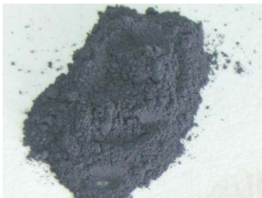
รูปที่ 4.16 สีตัวเร่งปฏิกิริยา (ก) ตัวเร่งปฏิกิริยาก่อนทดลอง (ข) ตัวเร่งปฏิกิริยาหลังการทดลองการเติมซิลเวอร์ในเตรต
