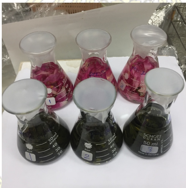
รูปที่ 2-4 ขั้นตอนการสกัดด้วยวิธีการแช่ด้วยตัวทำละลายเพนเทน
