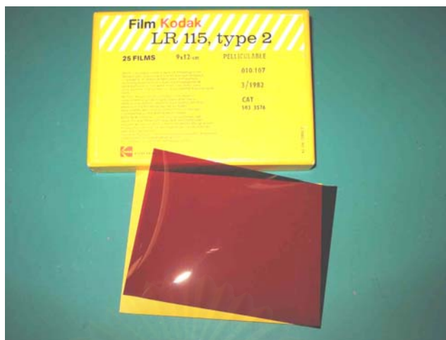
รูปที่ 3.6 ลักษณะของฟิล์ม LR-115 Type 2 ที่ใช้ในงานวิจัย
