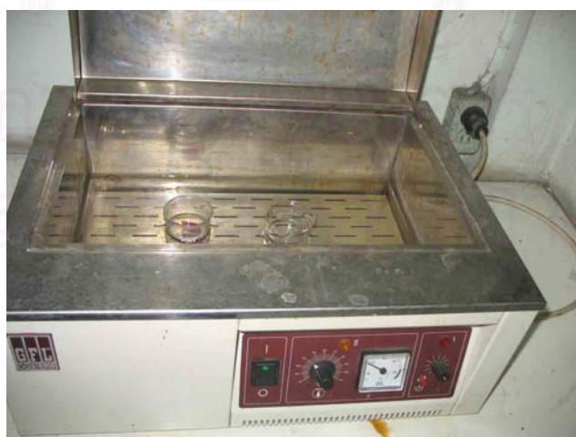
รูปที่ 3.10 การกัดรอยด้วยสารละลายโซเดียมไฮดรอกไซด์ ใน Water bath
