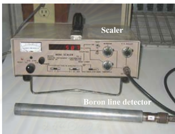
รูปที่ 3.5 อุปกรณ์นับรังสี Eberline และหัววัดชนิด Boron line detector
