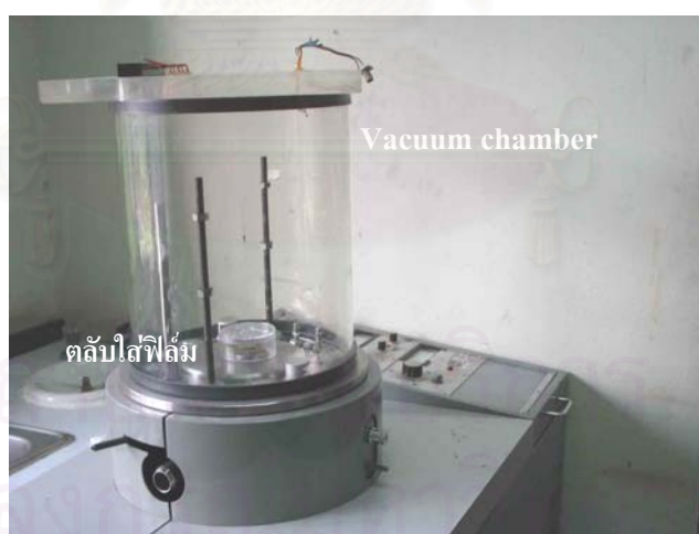
รูปที่ 3.14 การอบฟิล์มด้วยอนุภาคแอลฟาใน Vacuum chamber
