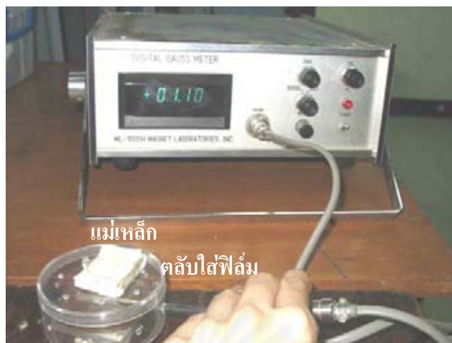
รูปที่ 3.12 การวัดค่าความเข้มสนามแม่เหล็กบริเวณตำแหน่งที่ทำการติดตั้งฟิล์มด้วย Gauss meter
