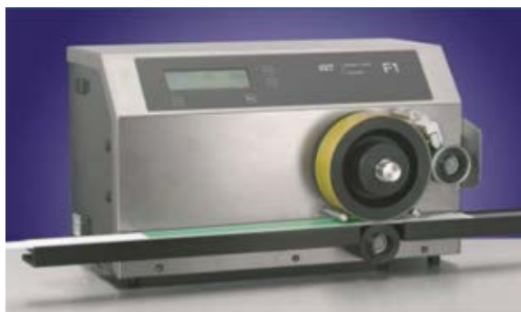
รูปที่ 3.1 เครื่อง IGT F1 Printability Tester [25]
