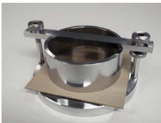
รูปที่ 2.3 อุปกรณ์การทดสอบการซึมซับน้ำ ด้วยวิธี cobb test [11]
