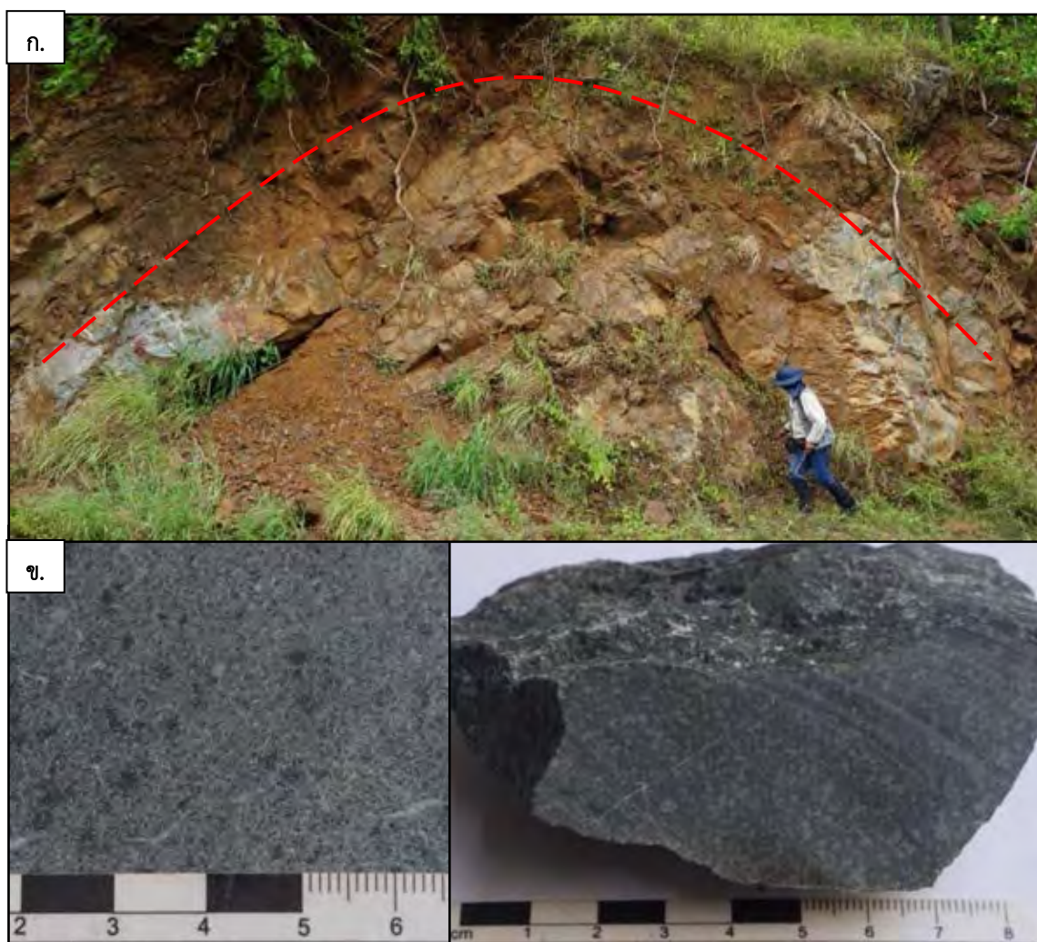
รูป 3.7 หินไมโครไดออไรต์ ที่พบในพื้นที่ลำสนธิ ณ บริเวณเขาขวาง ก. แสดงลักษณะของหินโผล่ถนนตัด (road cut outcrop) ณ เขาขวาง อำเภอลำสนธิ จังหวัดลพบุรี ซึ่งมีขนาดประมาณ 5x11 เมตร แสดงลักษณะเป็นพลูตอน (pluton) ข. แสดงลักษณะของหินไมโครไดออไรต์ที่พบ ที่มีผลึกแร่ขนาดเล็ก
