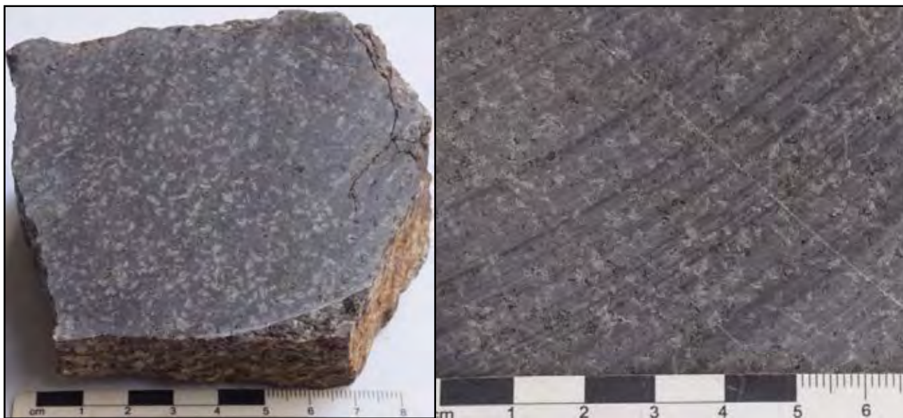
รูป 3.5 หินแอนดีไซต์เนื้อดอก พบลักษณะเนื้อดอกที่มีทั้งผลึกดอกชนิดเดียว ที่เป็นแร่แพลจิโอเคลส และผลึกดอกสองชนิด ที่เป็นแร่แพลจิโอเคลส กับแร่ฮอร์นเบอร์น
