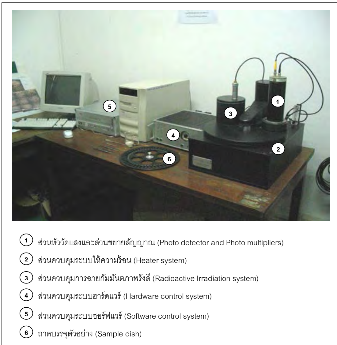
รูป 1.14 เครื่อง Thermoluminescence Detector (TLD), ภาควิชาธรณีวิทยา คณะวิทยาศาสตร์ จุฬาลงกรณ์มหาวิทยาลัย (สันติ ภัยหลบลี้, 2545)
