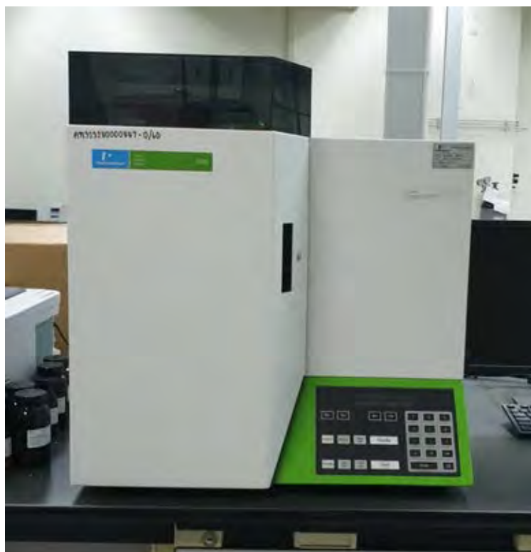
รูปที่ 3.2 เครื่องวิเคราะห์ปริมาณธาตุคาร์บอน ไฮโดรเจน ไนโตรเจน และซัลเฟอร์ (CHNS/O analyzer) ยี่ห้อ PerkinElmer รุ่น EA2400 Series II
