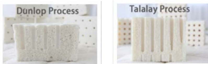
รูปที่ 2.7 ลักษณะโฟมยางจากวิธีดันลอปและวิธีทาลาเลย์ [5]
