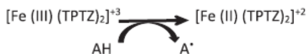
รูปที่ 2.4 ปฏิกิริยาที่เกิดขึ้นในการวิเคราะห์ FRAP
