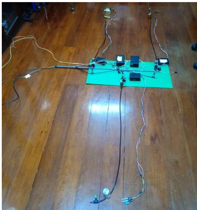
รูปที่ 4.13 ภาพแสดงระบบการให้น้ำพืชแบบแม่นยำด้วยระบบสมองกลฝังตัว
