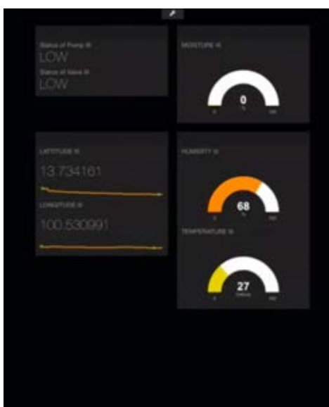
รูปที่ 4.7 ภาพการแสดงผลการทำงานของระบบควบคุมการให้น้ำพืชผ่านหน้าเว็บไซต์ NETPIE (ขณะค่าที่วัดได้ไม่ตรงเงื่อนไข)
