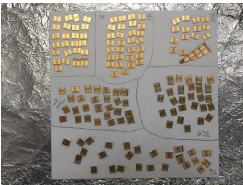
รูปที่ 3.13 การตากแห้งของเซนเซอร์ฟิล์มบางบนแผ่นเซรามิก
