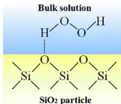
รูปที่ 2.2 การสร้างพันธะระหว่าง Siloxane และไฮโดรเจนเปอร์ออกไซด์ (ที่มา: Tu et al. (2012))
