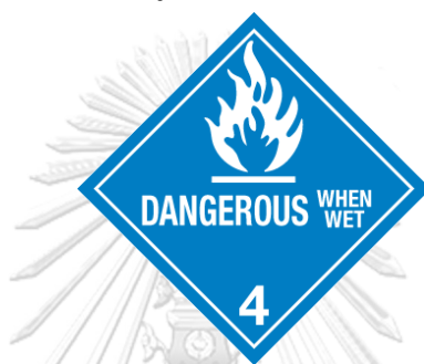
รูปที่ 2.7 ป้ายสัญลักษณ์ในการขนส่งตะกั่วอะลูมิเนียม
