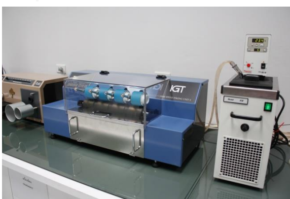
ภาพที่ 3-3 เครื่องกลิ้งหมึก (IGT High Speed Inking Unit 4, HISU4)
