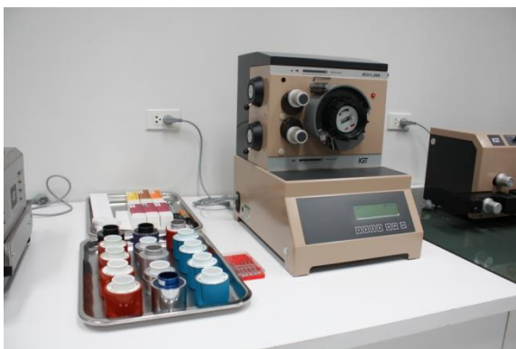
ภาพที่ 3-2 เครื่องทดสอบสภาพพิมพ์ได้ IGT AIC2-5T2000
