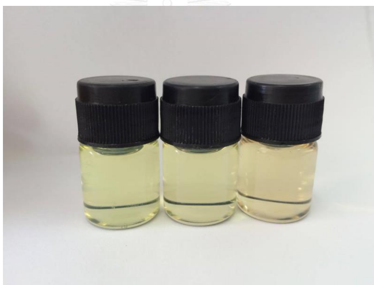
รูปที่ 4.3 การเปรียบเทียบสีของน้ำมันดีเซล (ซ้าย) และน้ำมันดีเซลที่เติมสารประกอบ 2 ที่ความเข้มข้น 5 (กลาง) และ 10 ppm (ขวา)
