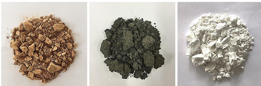
ภาพที่ 3.1 วัตถุดิบที่ใช้ในการผลิตอิฐดินเผาและอิฐมวลเบา ประกอบด้วย (ก) ดินราชบุรี (ข) ถ้ำหนักกลไกไนต์ และ (ค) แบบพิมพ์ปูนพลาสติกอร์ใช้แล้ว (บดหยาบ)
