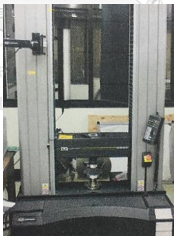
ภาพที่ 3.6 เครื่องทดสอบยูนิเวอร์แซล (Universal test machine)
