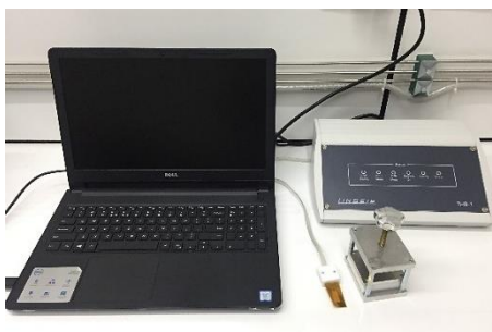
ภาพที่ 3.9 เครื่องวิเคราะห์การนำความร้อนด้วยเทคนิคฮอตดิสก์ (Hot-disk method)
