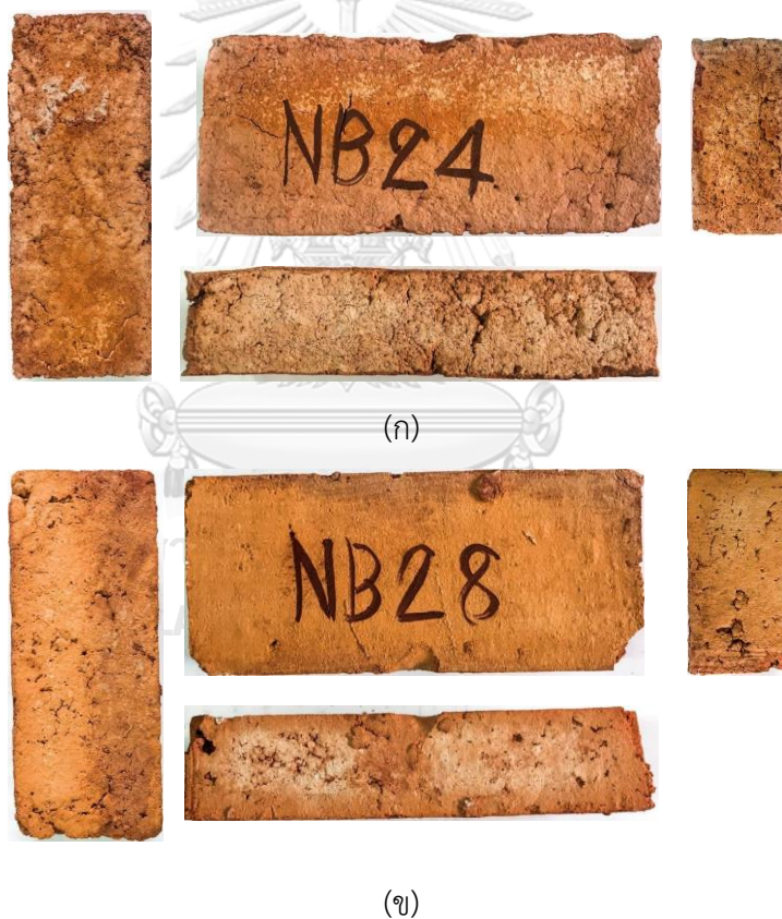
ภาพที่ 2.29 อิฐดินเผามวลเบาสูตร ประกอบด้วย (ก) สูตร NB24 และ (ข) สูตร NB28 [47]
