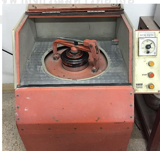
ภาพที่ 3.5 เครื่องบดแบบสั่น (Vibratory mill) และหม้อบดแบบถังสแตนคาร์ไบด์
