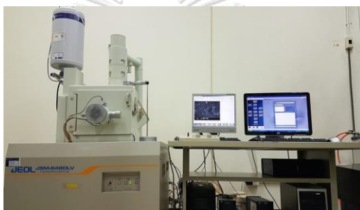
ภาพที่ 3.10 กล้องจุลทรรศน์อิเล็กตรอนแบบส่องกราด
