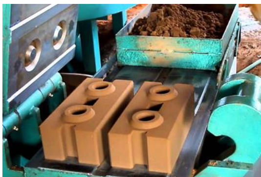
ภาพที่ 2.6 อิฐขึ้นรูปด้วยเครื่องอัดพิมพ์ [13]
