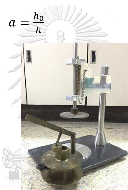
ภาพที่ 3.7 เครื่อง Pfefferkorn plasticity test และอุปกรณ์สำหรับเตรียมชั้นงานทดสอบ
