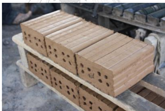
ภาพที่ 2.7 อิฐขึ้นรูปด้วยเครื่องอัดรีด
