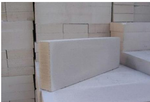
ภาพที่ 2.20 อีฐบล็อกจากมวลเบาแบบกักฟองอากาศ [14]
