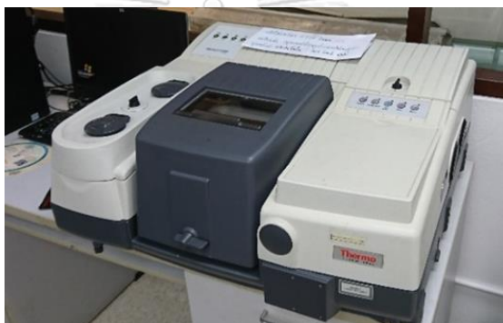
รูปที่ 3.2 เครื่องฟูเรียร์ทรานสฟอร์มอินฟราเรดสเปกโทรสโกปี รุ่น Nicolet 6700
