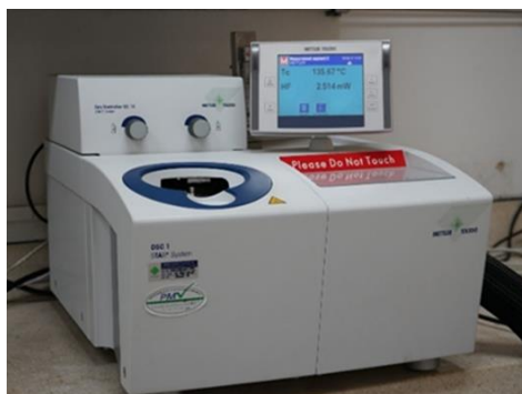
รูปที่ 3.9 เครื่องดีพีเพอเรนเชียลสแกนนิ่งแคลอริมิเตอร์ รุ่น DSC1/STAR e
