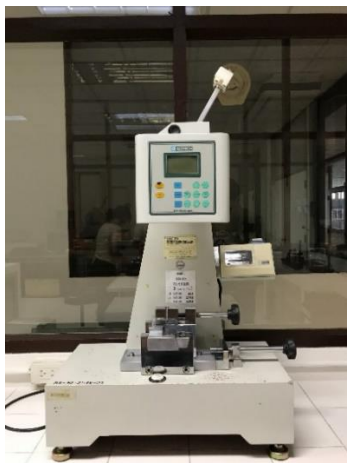
รูปที่ 3.6 เครื่องทดสอบความทนแรงกระแทก รุ่น GT-7045-MDH
